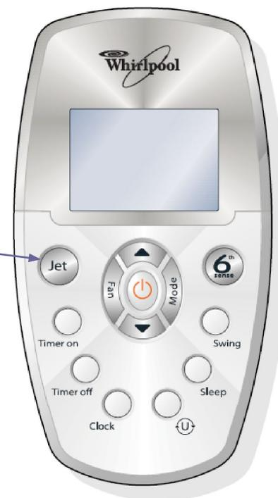
Режим «Быстрое охлаждение» (Jet) легко активируется кнопкой «Jet». Он устанавливает температуру автоматически на 18°C, а воздушный поток на максимальный, тем самым достигая наиболее быстрого охлаждения помещения.
