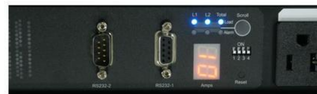
Два последовательных порта и индикатор значения тока
