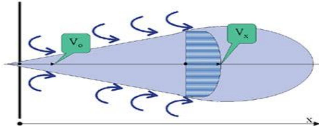
Движение воздуха, созданное струей, приводит к быстрому распространению приточного воздуха по всему помещению, что обеспечивает:
