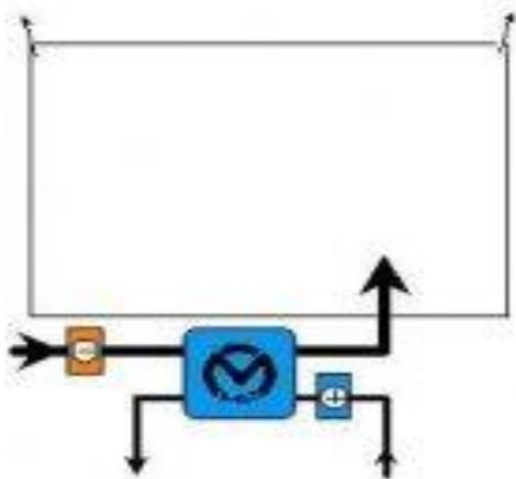
**3. Открытая система с предварительным охлаждением воздуха.** Часто оптимальное решение заключается в комбинировании двух методов осушки воздуха - конденсационного и адсорбционного.
