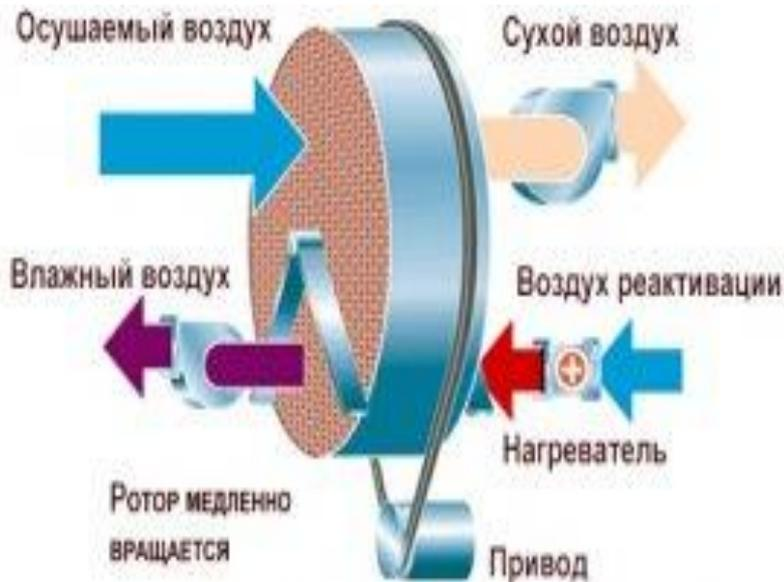
Главным элементом осушителей Munters является ротор, имеющий сотовую структуру, благодаря чему достигается большая площадь контакта поверхности с воздухом. Материал ротора обработан особым составом, например, на основе силикагеля. Ожидаемый срок эксплуатации ротора составляет 15 лет.
