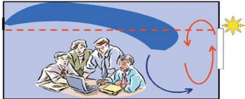
При подаче холодного воздуха вдоль потолка очень важно обеспечить достаточно высокую начальную скорость, иначе струя не будет настилаться. В любом случае, на определенном расстоянии от приточного отверстия поток отрывается от потолка и опускается вниз.
