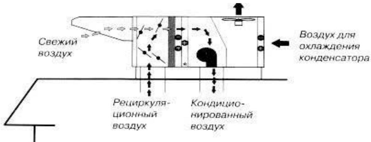
это моноблоки для открытой установки на плоских кровлях зданий, которые позволяют осуществлять вентиляцию с притоком свежего воздуха и кондиционирование помещений.
