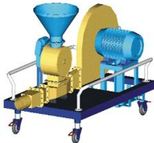
Из бункера материал через шлюзовой затвор поступает в материалопровод где подхватывается потоком воздуха, нагнетаемого вентилятором, и транспортируется к месту выгрузки.
