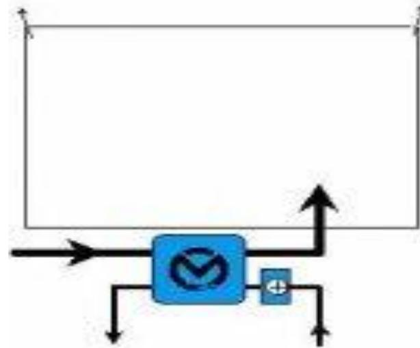
**2. Открытая система** (осушение наружного воздуха и подача его в помещение) используется тогда, когда невозможно применение закрытой системы.
