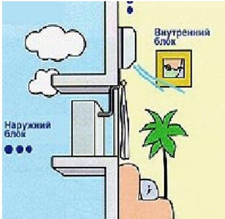
**Сплит-системы** – самый популярный тип кондиционеров. Они состоят из двух блоков, что позволяет значительно снизить уровень шума в помещении. Блок, содержащий испарители и нагнетатели воздуха, устанавливается в помещении, а блок, содержащий компрессоры и вентиляторы, устанавливается снаружи.
