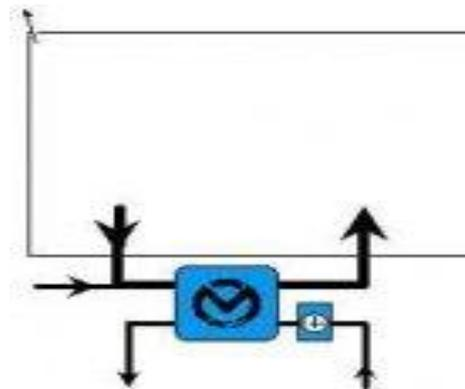
**4. Закрытая система с подмешиванием наружного воздуха** применяется при необходимости вентиляции помещения и/или для создания избыточного давления (подпора).
