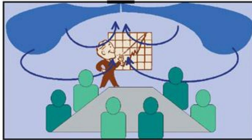
Если приточное отверстие расположено рядом с поверхностью ограждения, струя настиляется на эту поверхность.
