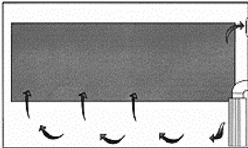
Заключается в использовании естественных конвективных потоков, восходящих от тепловых источников в помещении. Чистый, слегка прохладный воздух подается в нижнюю зону помещения с малой скоростью и затопливает рабочую зону, вытесняя нагретый загрязненный воздух в верхнюю зону, в результате чего взвешенные в воздухе вредности благополучно покидают вентилируемые помещения через вытяжные устройства
