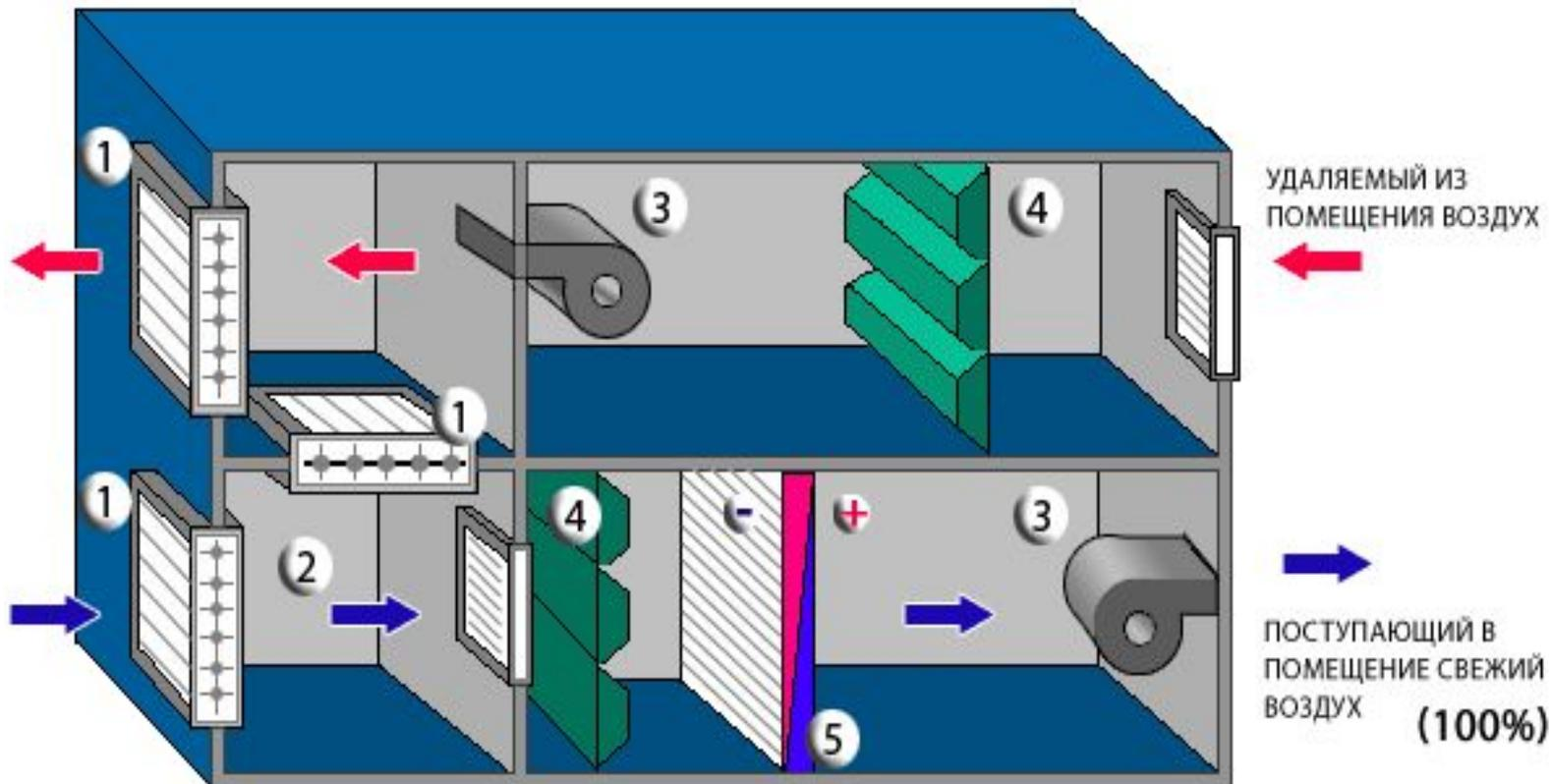
Вентиляция с притоком и вытяжкой одинакового количества воздуха
