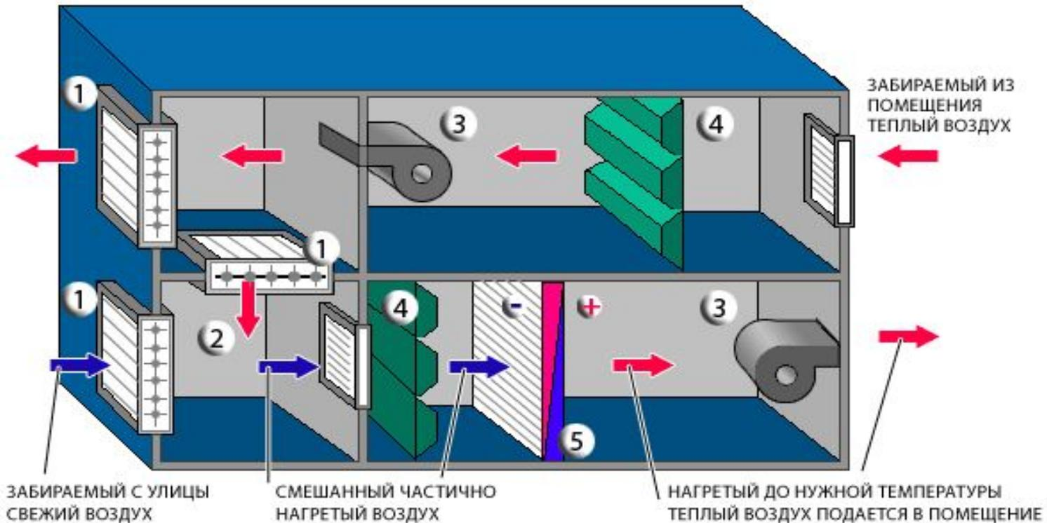
Воздух подается с частичным забором наружного воздуха и частичным подмешиванием воздуха из помещения
