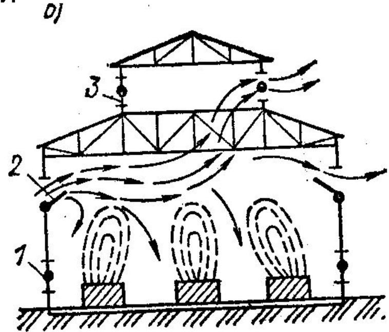
Схема аэрации цеха 1— проем первого яруса; 2— проем второго яруса; 3— вытяжной проем
