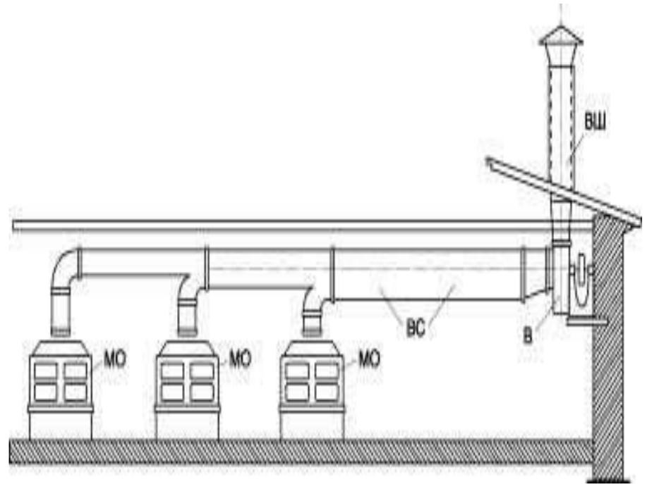
Удаление загрязненного воздуха непосредственно от источников вредных выделений или подачи воздуха в определенную часть помещения или к рабочим местам называется **местной вентиляцией**.
