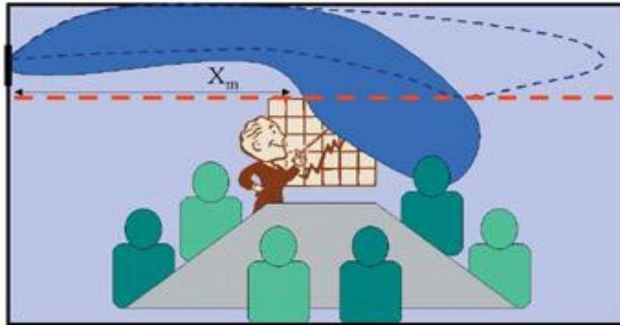
При неизотермических условиях характер процесса усложняется, так как температурные воздействия на струю отклоняют ее вниз
