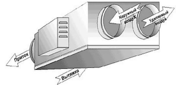
**В спиральном корпусе с двумя всасывающими и двумя выпускными отверстиями и рабочим колесом из пористого материала одновременно производится перемещение наружного вытяжного воздуха и обмен тепла. Рабочее колесо вентилятора служит при этом для передачи тепла. КПД теплообмена не зависит от разницы температур.**
