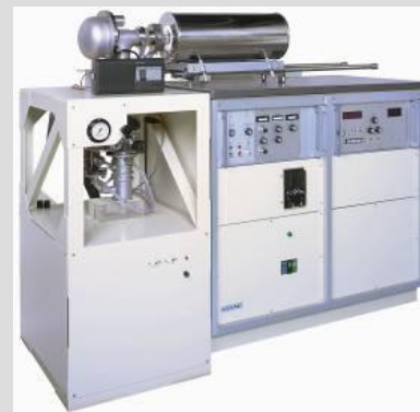
Установка для исследования внутреннего трения в металлах IFT-1500M
