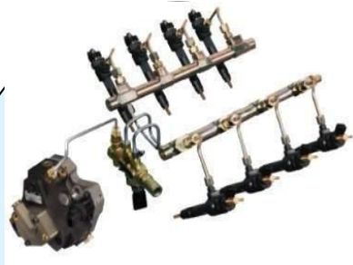
Система топливоподачи типа Common Rail
