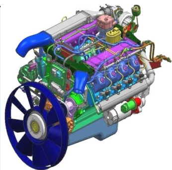
Двигатели уровня Евро-4, с системой топливоподачи Common Rail
