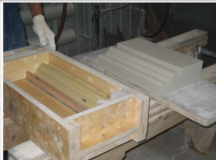
Изготовление изделий происходит путем уплотнения готовой смеси в форму и последующего ее разъема.
