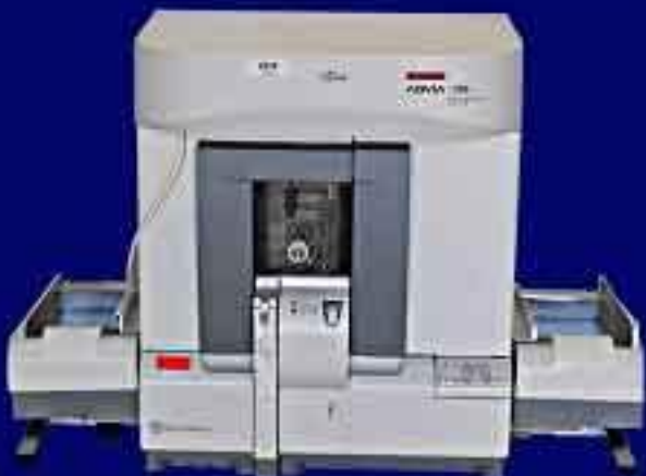
Гематологический анализатор Advia 2120 Использовался для предварительного отбора венозной крови
