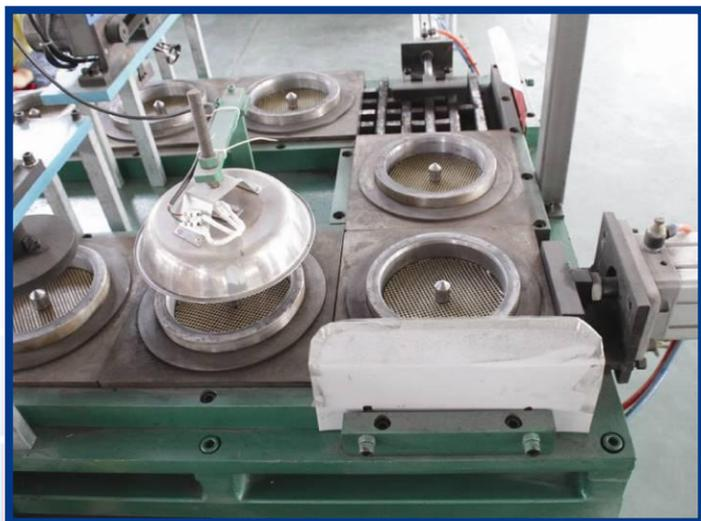
Автомат по разравниванию «засыпки» обеспечивает равномерную плотность структуры, которая положительно отражается на балансировке круга. Во время работы таким кругом УШМ не вибрирует, что позволяет осуществлять качественный и безопасный рез.
