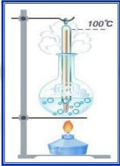
1. При нагревании **испарение с поверхности воды усиливается.**
