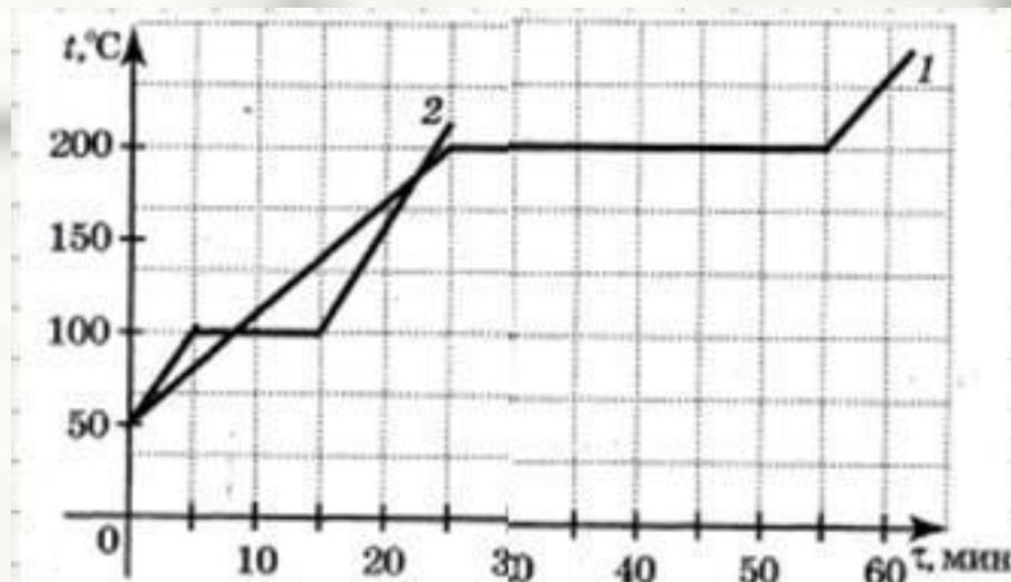
**ГИА-2010-8.** На графике показаны кривые нагревания одинаковых масс двух разных жидкостей при одной и той же постоянной мощности подводимого количества теплоты. Отношение удельной теплоты парообразования первой жидкости к удельной теплоте парообразования второй жидкости равно
