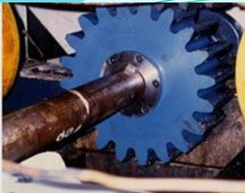
Материал капролон используется для гелмпортных втулок баллеров, подпятников ахтерштевня, судовых дейдвудных и рулевых подшипников, подшипников скольжения механизмов, шестерен, канатных блоков, втулок управляющих тяг румпеля и винторулевых колонок. Низкое трение и самосмазывающие свойства уменьшают усилия поворота руля. Корректировка курса становится более легкой с меньшим запаздыванием. Повышение точности при прокладке курса экономит топливо.
