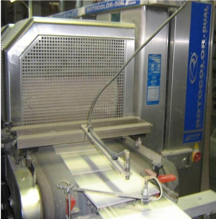
Для того, чтобы придать эстетичность, долговечность, водонепроницаемость, глянцевую поверхность, легкость в поддержании чистоты, основа плитки (бисквит) покрывается ангобом (подглазурный слой), а затем глазурью.
