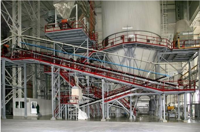
**Все сырьевые материалы, согласно рецепта, загружаются в шаровую мельницу. Совместный помол длится 3 часа затем, так называемый шликер сливается в приёмную мешалку, где хорошо перемешивается и подаётся при помощи насоса на башенно-распылительное сушило (БРС).**
