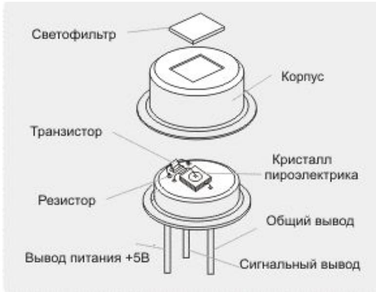
При фоновом освещении заряды уравниваются друг друга, а в моменты возникновения и исчезновения инфракрасного излучения на выходе пиродатчика появляется переменное напряжение. Другими словами, пирозлектрическая пластина датчика с двумя металлическими обкладками способна поглощать электромагнитные волны инфракрасного диапазона. В результате такого поглощения между обкладками пирозлектрика возникает разность потенциалов.
