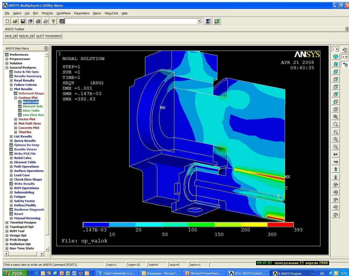
используется пакет ANSYS, что позволяет выявить наиболее слабые места и выполнить расчет статической прочности станков
