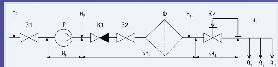
**Рис. 1. Пример упрощенной технологической схемы с насосным агрегатом**
