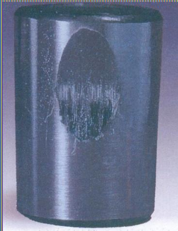
**Износ ролика подшипника в машине трения Тимкина при использовании обычных литевых смазок отечественного и импортного производства**
