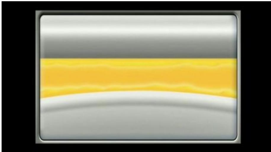
Механизм образования защитной пленки присадок на поверхности металла
