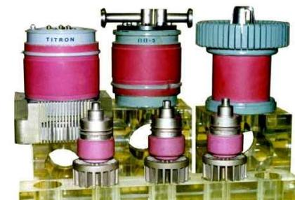
электроды, реализована идеальная пентодная характеристика, оригинально решена проблема электрической прочности, на частотах до 1 ГГц обеспечивается КПД 70-80%. Титрон в схеме превращает источник напряжения в «безинерционно» меньше времени развития пробоя) управляемый источник тока, что позволяет эффективно работать со склонными к пробоям нагрузками типа Плазмы
