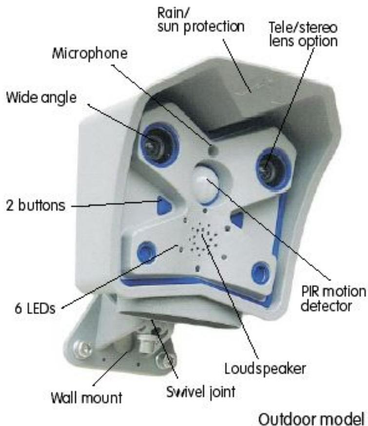
Поддержка технологий VoIP (Voice over IP) и SIP позволяют вести **удаленный разговор** с абонентом при помощи обычного IP-телефона!
