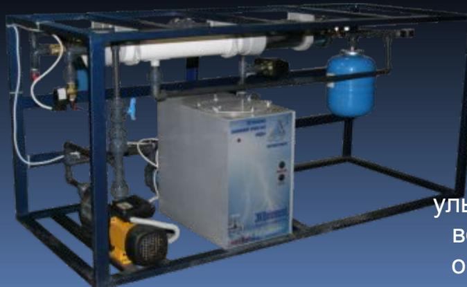
Система озон-ультрафильтрационной очистки воды со степенью обратного осмоса ЭКОelement (UF-RO)
