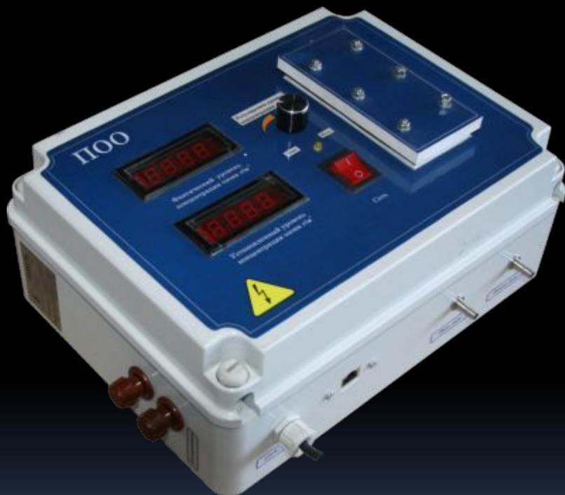
Блок автоматического поддержания концентрации остаточного озона в воде
