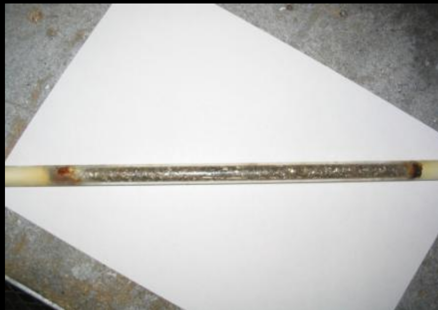
Состояние электродов озонатора серии Q после 2 лет непрерывной эксплуатации (отложения на электроде отсутствуют! )
