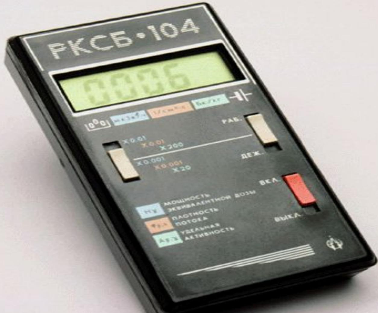
Он выполняет функции дозиметра и радиометра;
