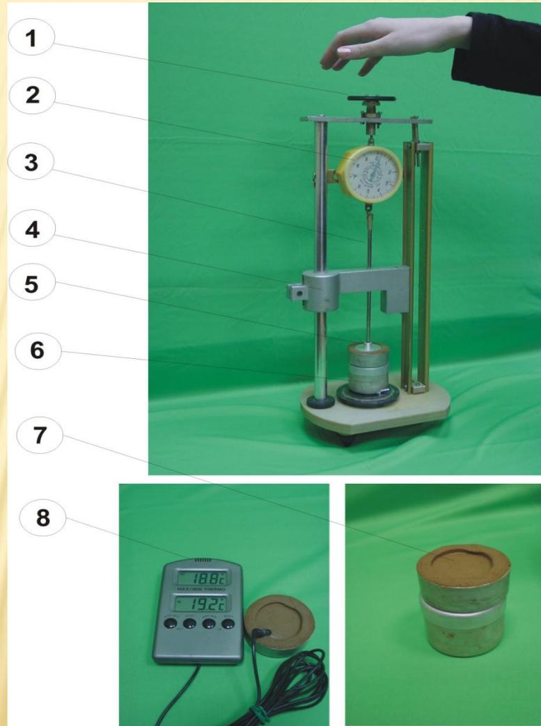
Рис. 2 Прибор для определения липкости
