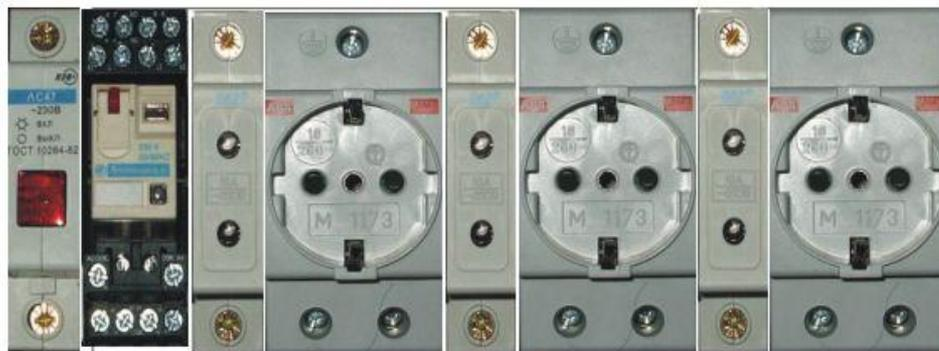
Простой блок без защиты отдельных розеток на 8 розеток (4 полных 4 тонких) в трех группах (2x12) с зуммером, с переключением на резервную возвратную помпу в случае срабатывания УЗО или автомата защиты на основной и автоматическим включением батарейного компрессора при пропадании питания или срабатывания любого УЗО
