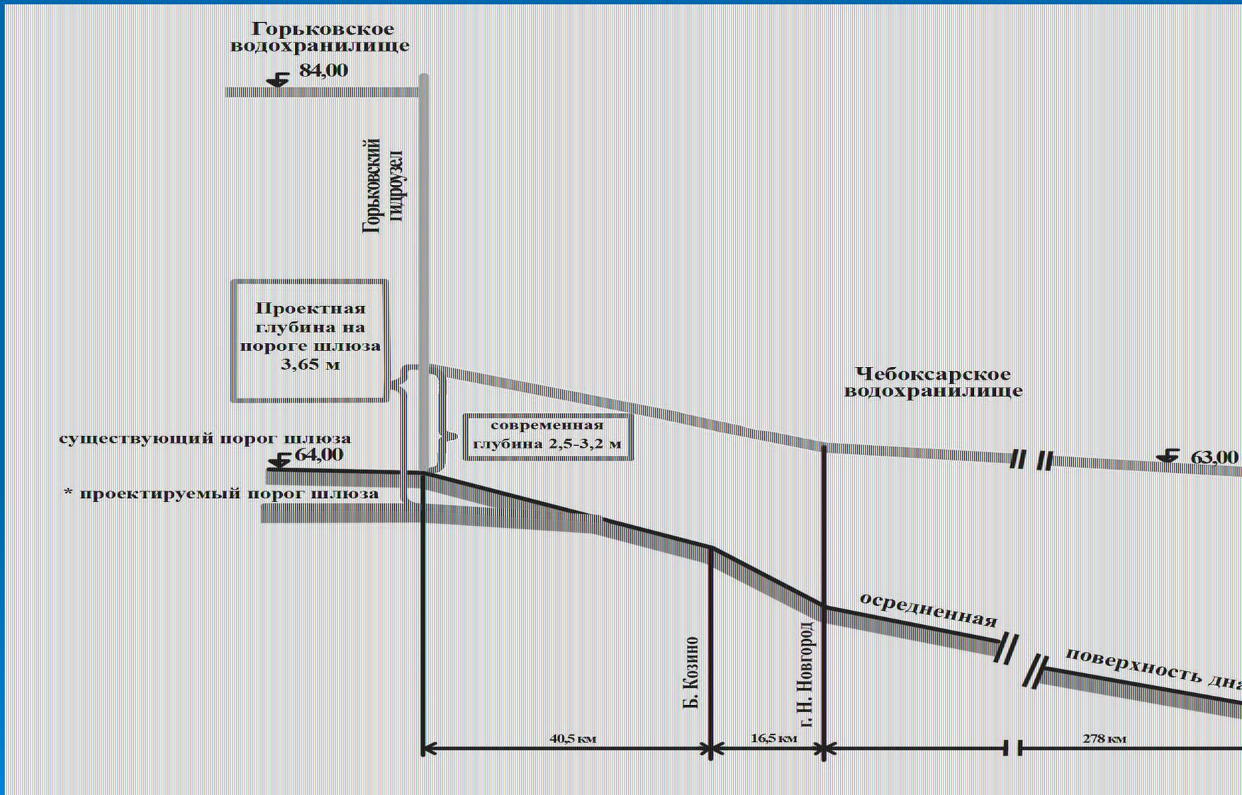
\* - отметка порога устанавливается в зависимости от уровня нижнего бьефа
