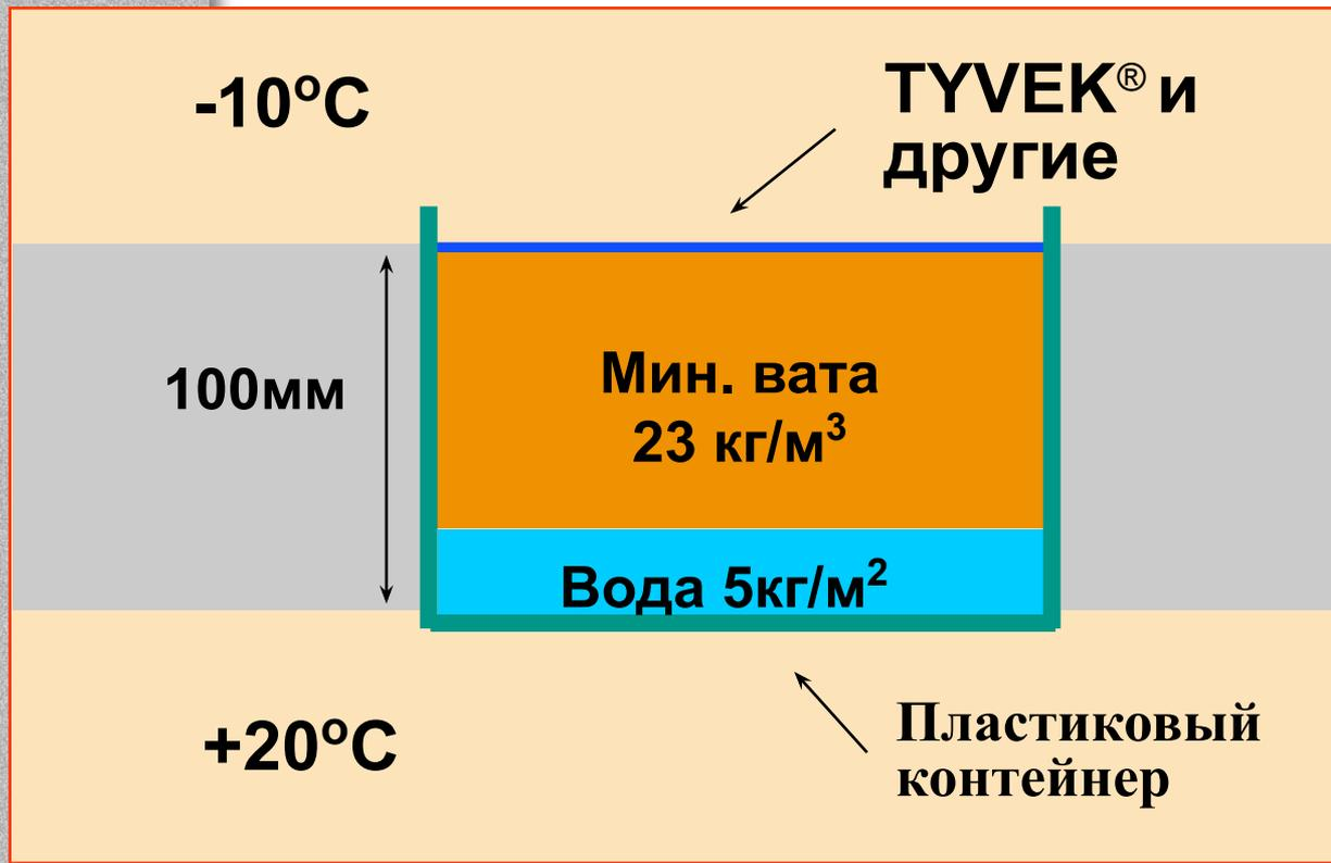
С течением времени измерялась масса воды. На поверхности теплоизоляции находились различные материалы.
