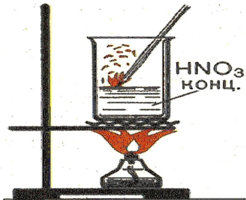
Рис. 23. Воспламенение тлеющей лучинки в нагретой концентрированной азотной кислоте.
