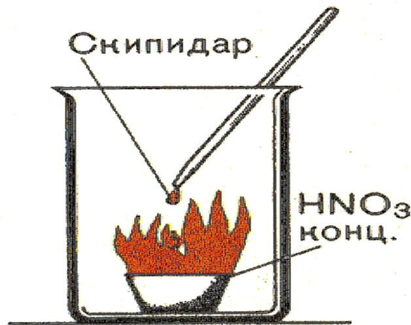
Рис. 24. Воспламенение скипидара в концентрированной азотной кислоте.
