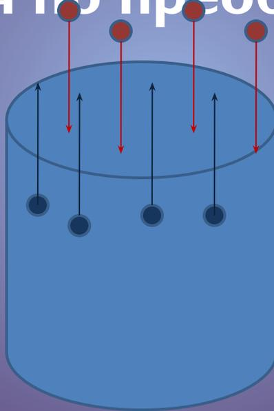
$V_{\text{испарения}} = V_{\text{конденсации}}$
