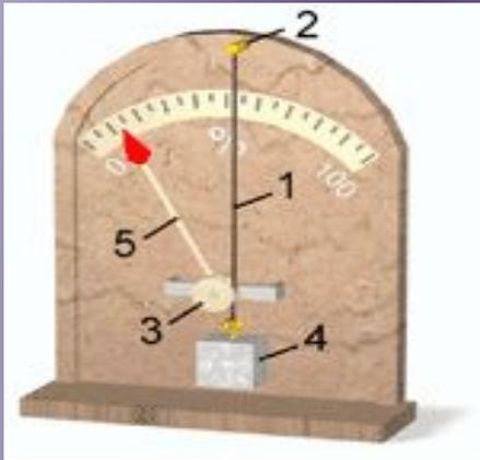
В качестве детали, чувствительной к изменению влажности, служит обезжиренный человеческий волос (1). Он закреплен в верхней части прибора (2), обернут вокруг ролика (3) и натянут при помощи специально подобранного груза (4). К ролику прикреплена стрелка (5). При увеличении относительной влажности воздуха волос удлиняется и вызывает вращение ролика вместе со стрелкой.
