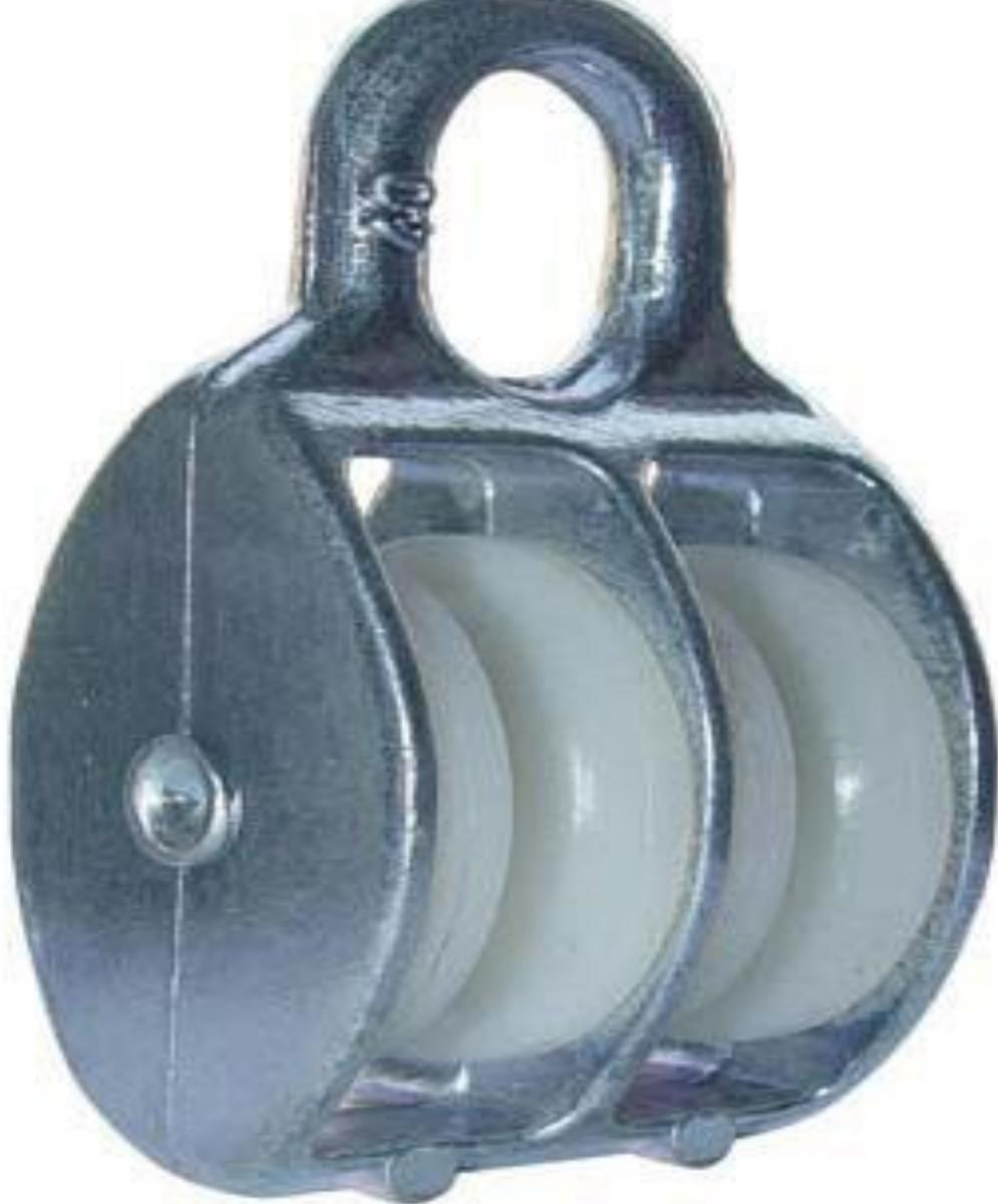
**Блок** — простое механическое устройство, позволяющее регулировать силу, ось которого закреплена при подъеме грузов, не поднимается и не опускается. Представляет собой колесо с желобом по окружности, вращающееся вокруг своей оси. Жёлоб предназначен для каната, цепи, ремня и т. п. Ось блока помещается в обоймах, прикреплённых на балке или стене, такой блок называется неподвижным; если же к этим обоймам прикрепляется груз, и блок вместе с ними может двигаться, то такой блок называется подвижным.
