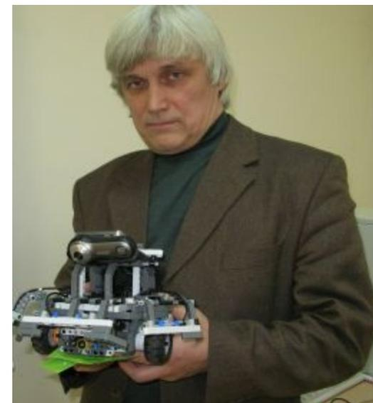
Самообучаемая система распознавания мобильного робота «Гном №9» самостоятельно формировала образы разных типов препятствий: «стенка», «край стенки слева», «край стенки справа», «ворота» и т.п. И затем распознавала их.
