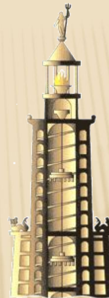
Этот рисунок восстанавливает вероятное внутреннее строение маяка. Он изображает огонь в верхней части и пандус, поднимающийся вверх по спирали
