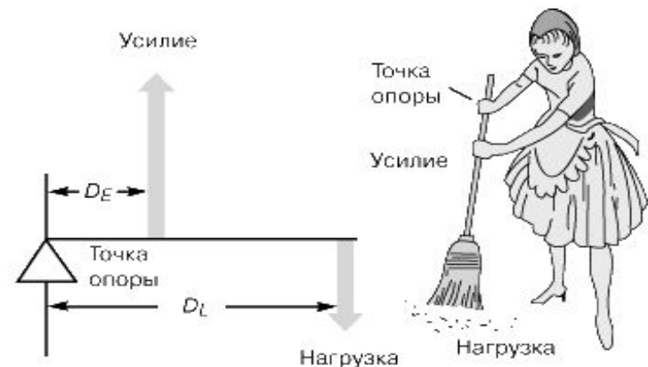
РЫЧАГ III РОДА (усилие между точкой опоры и нагрузкой)
