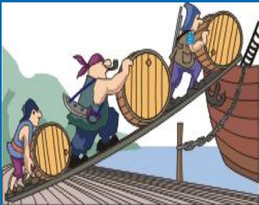
Наклонную плоскость применяют, чтобы получить выигрыш в силе, то есть при помощи меньшей силы противодействовать большей силе. Взгляните на рисунок. Вкатывая бочки по наклонной плоскости, пираты прикладывают меньшую силу, нежели если бы они поднимали бочки на веревках. Другими словами, силы, прикладываемые пиратами, меньше веса бочек
