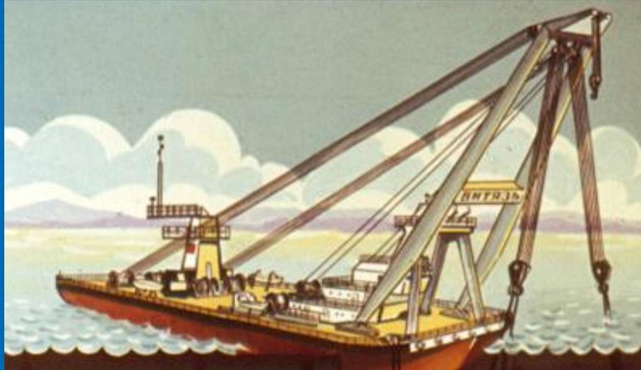
**Плавучие** краны - самые сильные из семейства подъемных кранов: их грузоподъемность 4000 кН. Они поднимают затонувшие корабли, снимают суда с мели, с их помощью ремонтируют суда в открытом море, опускают на дно батисферы и камеры для ремонта кабелей и трубопроводов.
