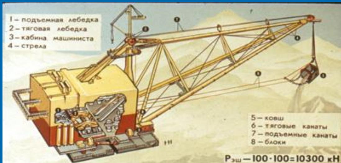
Простые механизмы используются и в устройстве **шагающих экскаваторов**
