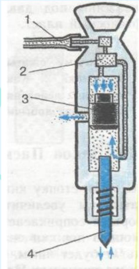
Устройство отбойного молотка показано на рисунке. По шлангу 1 подаётся сжатый воздух. Устройство 2, называемое золотником, направляет его поочередно то в верхнюю, то в нижнюю часть цилиндра. Под действием этого воздуха боек 3 начинает быстро перемещаться то в одну, то в другую сторону, периодически воздействуя на пику 4. Удары последней используют для разрыхления мерзлых грунтов, откалывания от массива кусков горных пород, угля.
