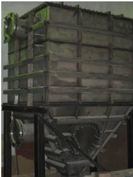
Опытная модульная установка газоочистки ФКИ-45
