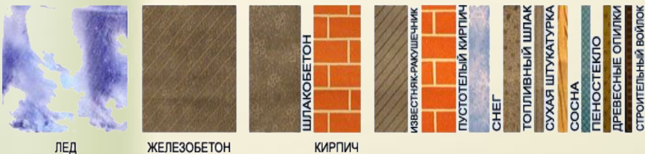
ШКАЛА ТОЛЩИНЫ МАТЕРИАЛОВ ПРИ ОДИНАКОВОЙ ТЕПЛОПРОВОДНОСТИ
