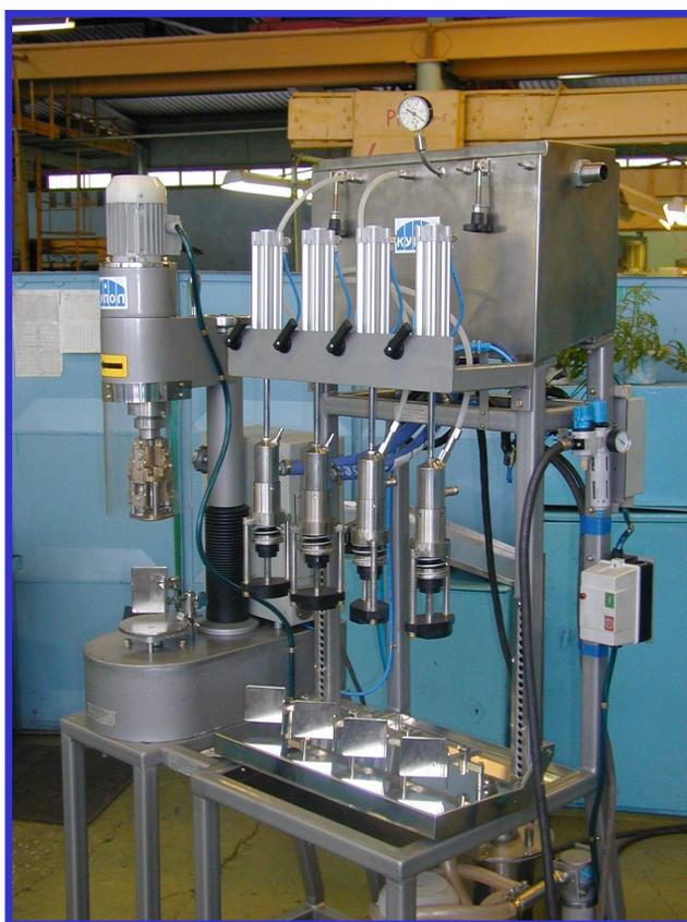
Установка упаковочная полуавтоматическая предназначена для фасования непенящихся (не содержащих углекислый газ) жидкостей по уровню в бутылки емкостью 0,25... 1,0 л, в том числе и сувенирные, и укупоривания их алюминиевыми колпачками с перфорированным отрывным кольцом или другими типами колпачков.
