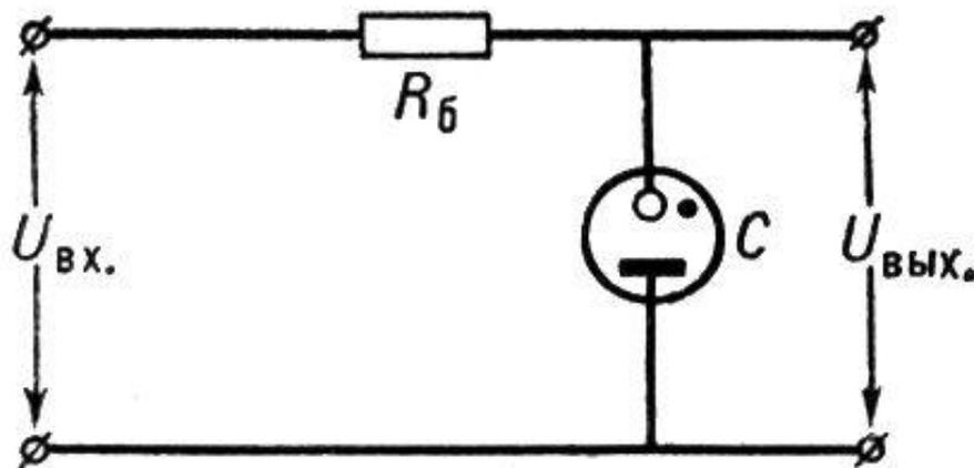
*Схема включения стабилитрона в параметрическом стабилизаторе напряжения*
