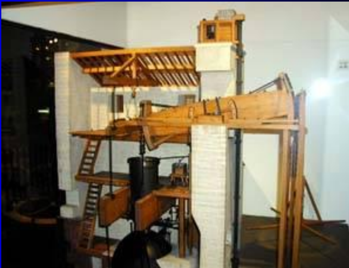
Пароатмосферная машина Т.Ньюкомена для подъема воды из шахты
