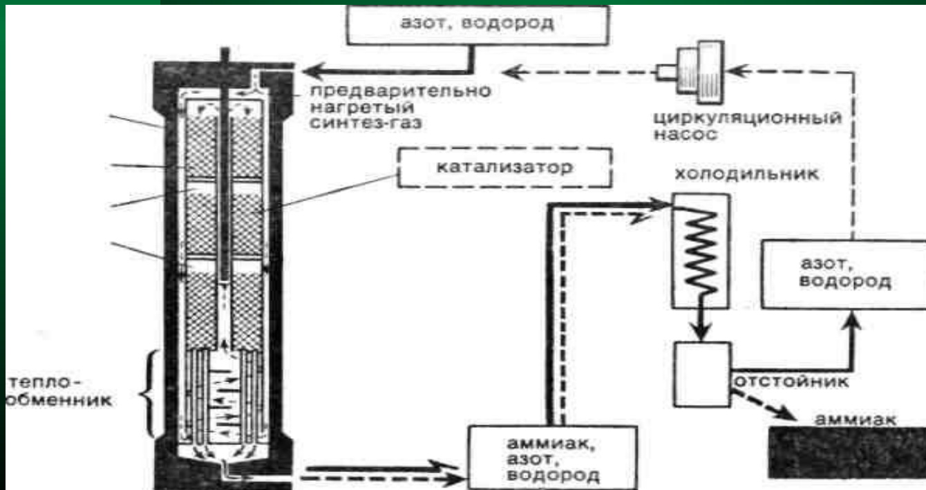
Рис. Устройство аппарата синтеза аммиака
