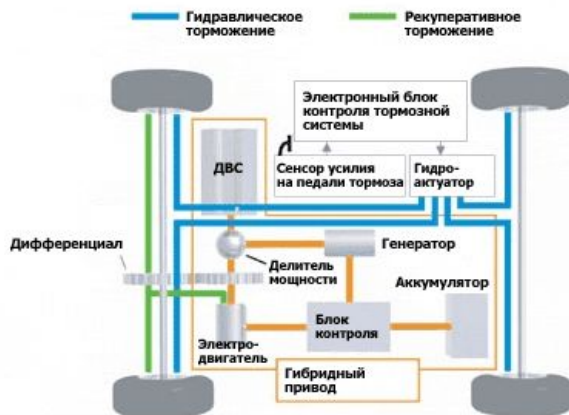
Схема трансмиссии легкового автомобиля
