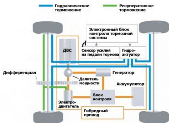
Схема трансмиссии легкового автомобиля
