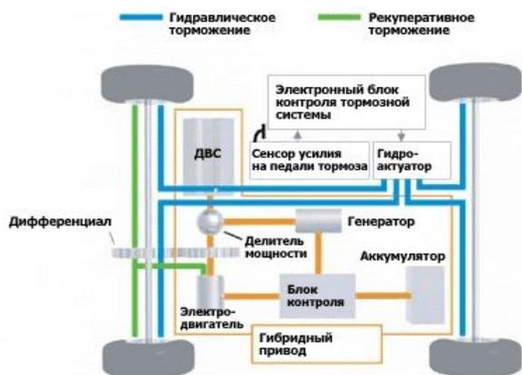
Схема трансмиссии легкового автомобиля
