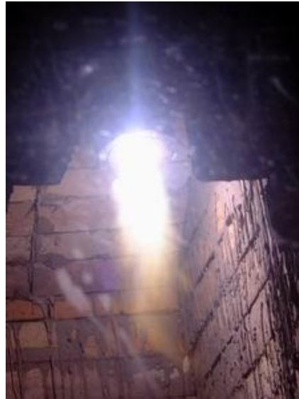
Факел плазмотрона в печи
