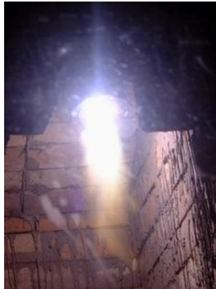
Факел плазмотрона в печи
