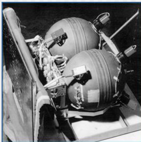
Комплект батарей 18NB-85 для спутников связи "Ямал" (эксплуатируются с сентября 1999 г.)
