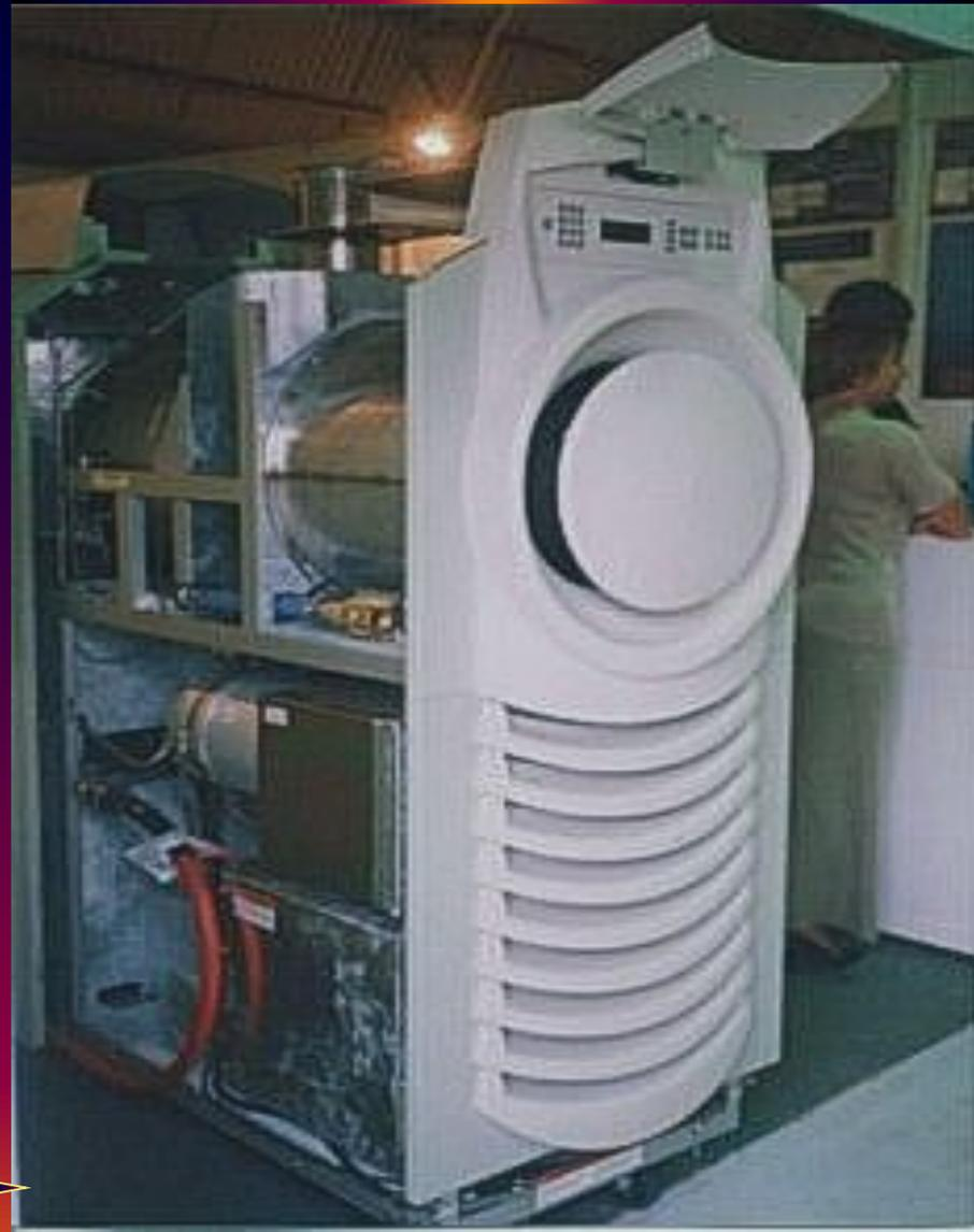
**Техническое обслуживание микротурбин в процессе эксплуатации чрезвычайно просто и заключается только в регулярной смене воздушного и топливного фильтров (через 4000 часов). При первом профилактическом ремонте, осуществляемом после 8000 часов непрерывной работы, производится профилактическая очистка камеры сгорания и замена насадок топливных форсунок. Ресурс до планово-восстановительного ремонта составляет 60 000 часов, при общем ресурсе более 200 000 час.**
