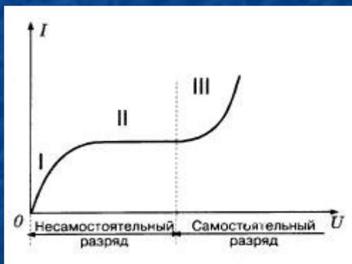
Ионизация осуществляется **электронным ударом**. Возможна при условии  $mv^2 \geq A_i$
