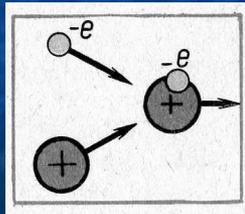
**Рекомбинация** – обратный процесс, т.е. процесс нейтрализации ионов.
