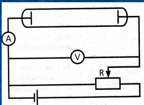
**Несамостоятельный** газовый разряд происходит под действием внешнего ионизатора (участки I и II на ВАХ).
