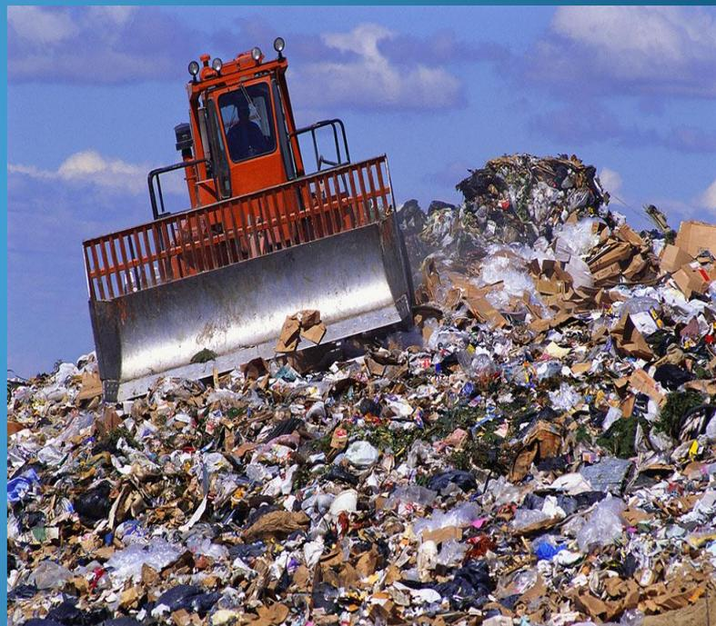
Любой полигон твердых бытовых отходов представляет собой большой биохимический реактор, в недрах которого в процессе эксплуатации, а также в течение нескольких десятилетий после закрытия в результате анаэробного разложения отходов растительного и животного происхождения образуется биогаз, или как его иногда называют, свалочный газ.
