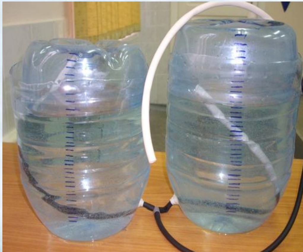
Схема и модель поплавкового спирометра
