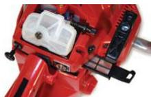
фильтр дополнительной очистки
