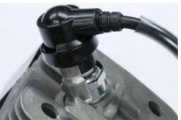
дополнительная фиксация колпачка свечи
