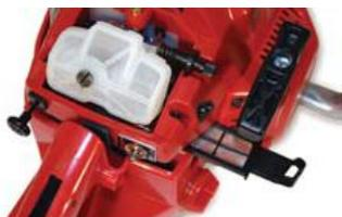
фильтр дополнительной очистки
