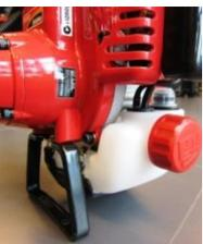
защитная опора двигателя
