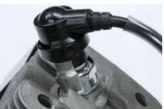
дополнительная фиксация колпачка свечи
