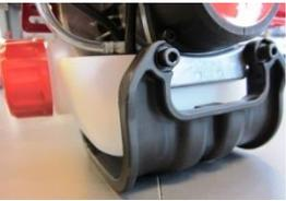
защита топливного бака
