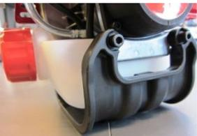
защита топливного бака
