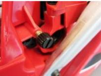
винт регулировки холостых оборотов
