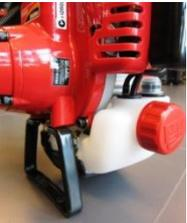
защитная опора двигателя
