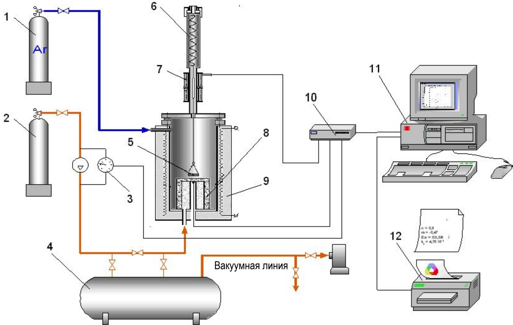
1, 2 - баллоны с газом-адсорбтивом и газом-разбавителем; 3 - прибор контроля давления рабочего газа; 4 - ресивер; 5 - таблетка; 6 - взвешивающая система; 7 - датчик измерения массы; 8 - пористый рассеиватель; 9 - нагреватель; 10 - контроллер; 11 - персональная ЭВМ; 12 - принтер
