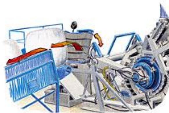
5. Готовые тюки переваливаются на конвейер готовых тюков. Процесс полностью автоматизирован, и упаковка одного тюка занимает 3-4 минуты. Вес тюка составляет 800 – 1150 кг, размер 1,2м x 1,2м).
