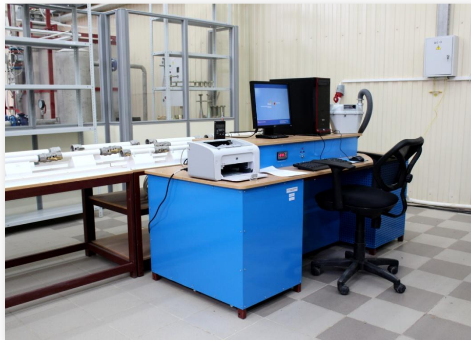
Установка УП ГСБР-6 для поверки бытовых счетчиков газа и расходомеров газа
