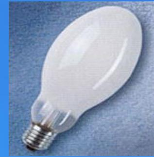
Ртутная лампа использует газовый разряд в парах ртути для получения света. Ртутные лампы дают свечение голубого цвета и интенсивное ультрафиолетовое излучение. Ртутные лампы применяются для медицинских целей, в светокопировальных аппаратах, в проекционных установках, для уличного освещения, но в настоящее время постепенно ртутные лампы заменяются на более экологически чистые натриевые лампы.
