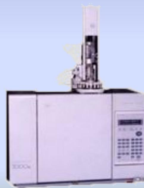
Предлагаемая Вашему вниманию автоматическая газохроматографическая система **UNICHROM** предназначена для детального углеводородного анализа (**DHA**) различных нефтяных фракций.
